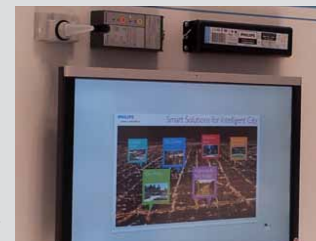
Eksempel på lysstyringssystem med antenne, driver, styringsenhed og monitor
