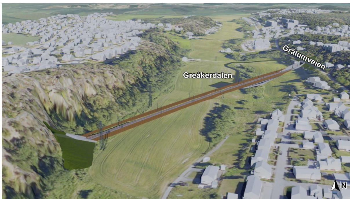
Figur 8-12: Alternativ 1a ved Greåkerdalen, sett mot nord. De brune linjene langs jernbanen er støyskjærmer
