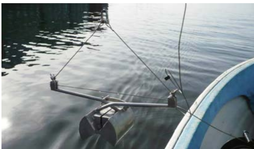
Bilde 1: sedimenthenter brukt for uttak av prøver.
