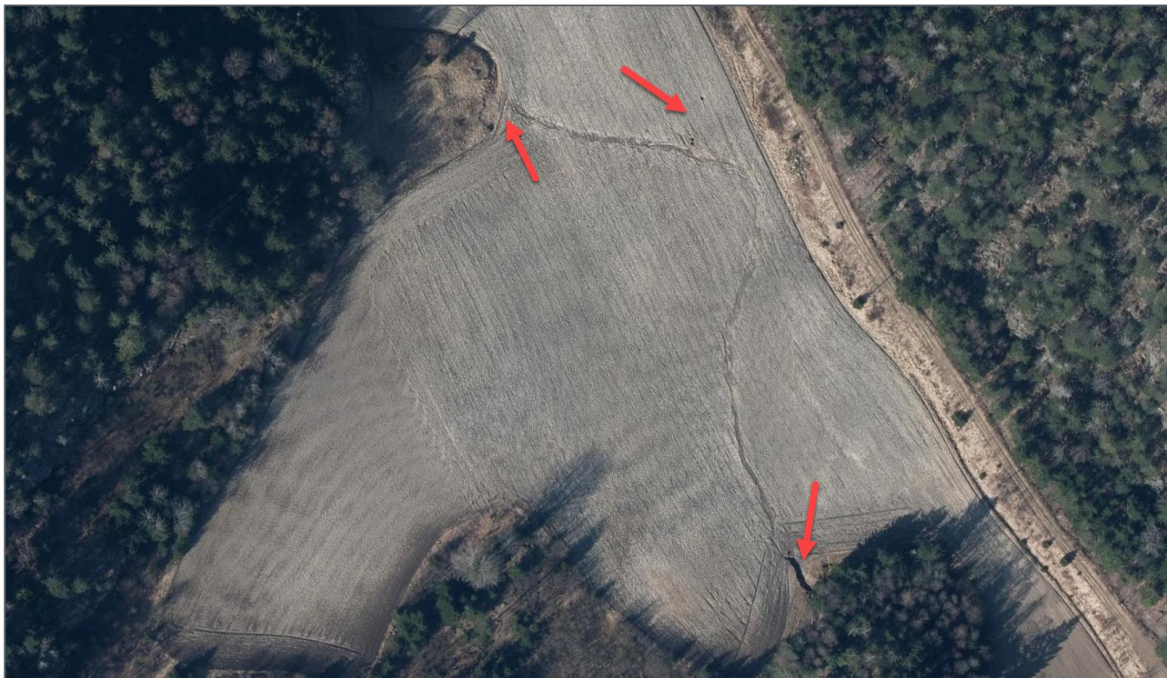
Figur 24: Erosjonsutfordringer på jordbruksareal et stykke oppstrøms Sølvstufoss. Røde piler peker på områder med mulige utfordringer med inntak av skogsvann til rørsystemet, erosjonshull knyttet til skader på rørsystem og erosjon i overgang mellom jorde og skog. Kilde: norgebilder.no med foto fra 18. april 2021 [11].
