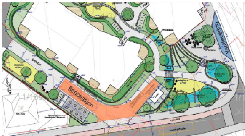
Vendehammer for renovasjonskjøretøy illustrert (In Situ/Rambøll)
