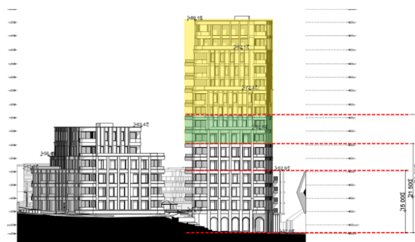
Figur 1: Høydeanalyse for bygg B, basert på fasadetegning med kotehøyder. Kilde: Plus arkitektur.
