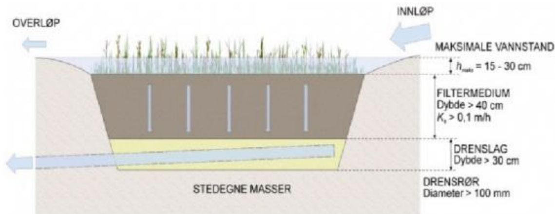
Figur 14 Prinsippskisse på utforming av regnbed. Kilde: Braskerud & Paus, 2016.
