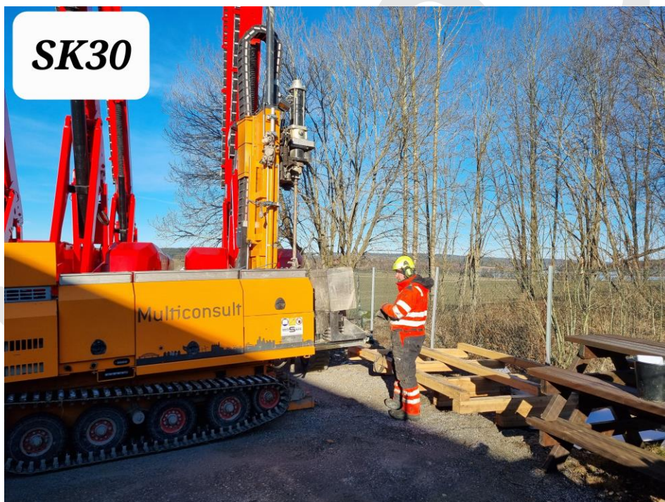
Figur 7. Fra skovling og prøvetaking av masser i SK30. Ikke påvist forurensning. Foto: Multiconsult
