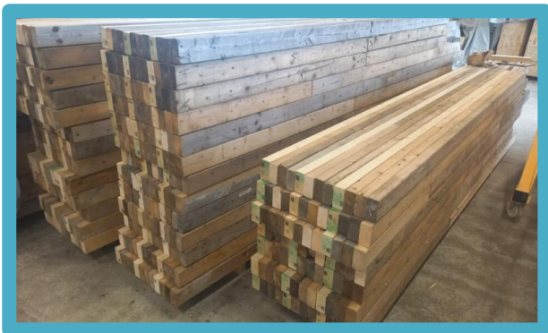
Veggelementer bestående av 1 del nytt og 3 deler returtre, brukt i låve i Noresund. 6
