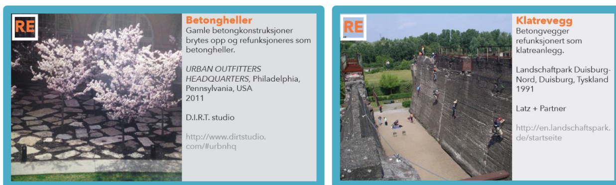
Eksempler på betongfragmenter ombrukt som hhv tråkkstein og klatrevegg i uteområde, hentet fra masteroppgave NMBU (Krogh 2014) 2
