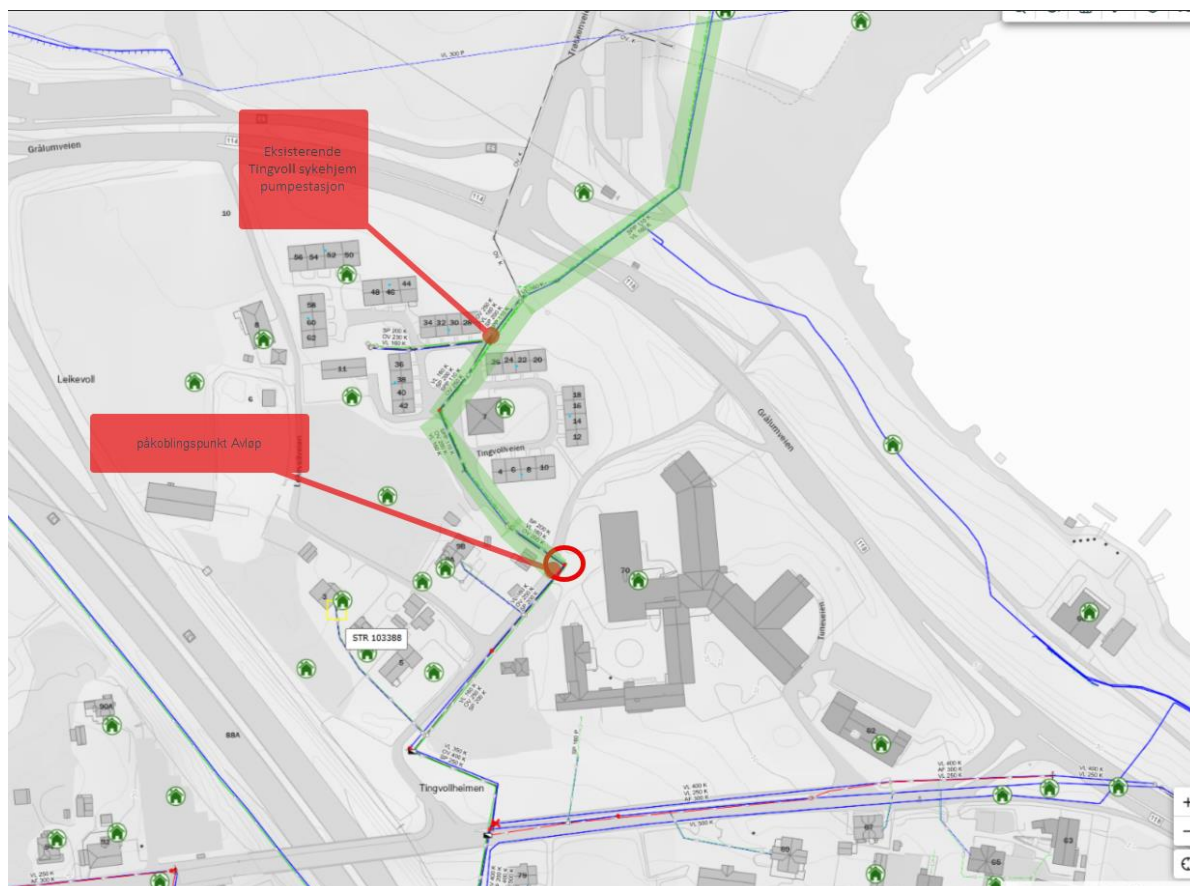
Figur 9 Utskifting av eksisterende spillvannsledning.
