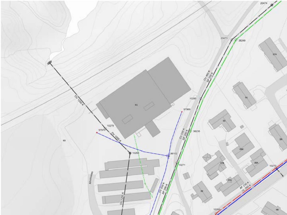
Fig 5 – VA-leddningsnett – utsnitt viser at det ligger en Ø1200 BET under jernbanen og som går over i en Ø1000 og som igjen øker til Ø1200 (hentet fra kommunens kartløsning).
