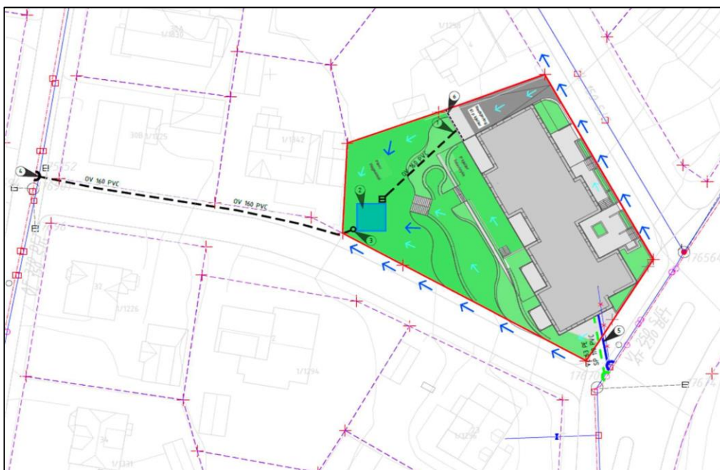
Figur 41: Planlagt ledningsnett og avrenningssituasjon
