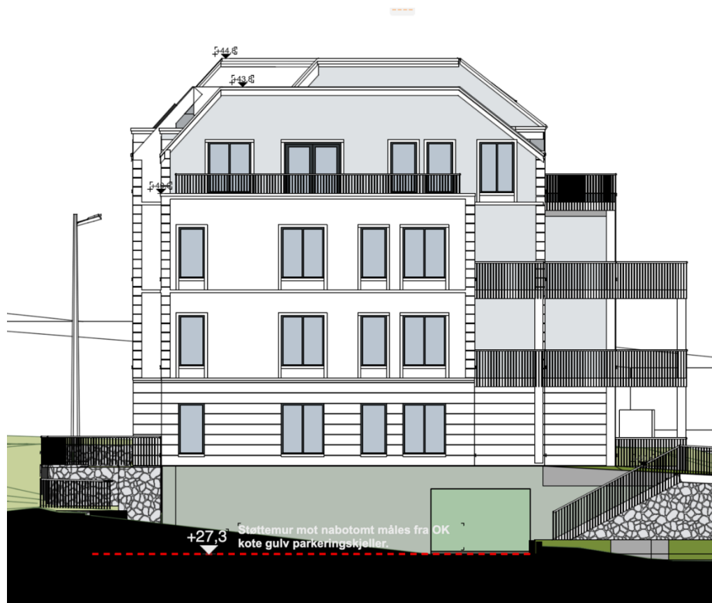
Figur 38 : Foreløpig skisse støttemur i eiendomsgrense mot nabotomt.
