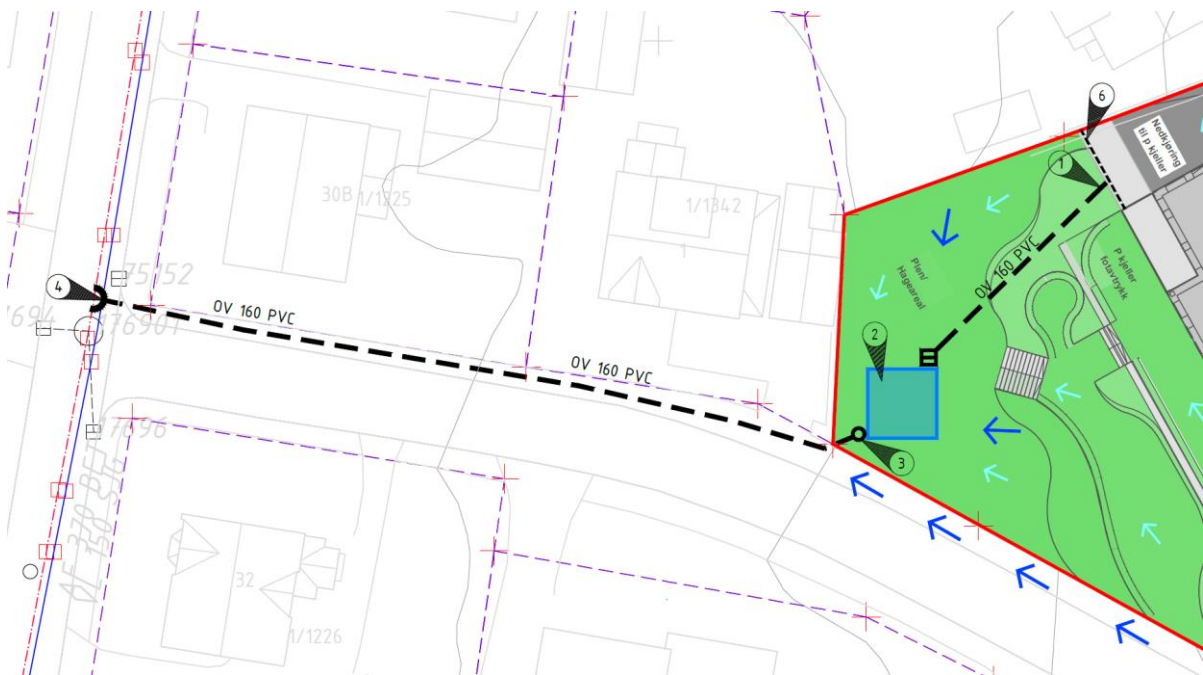
Figur 12: Trasé for overvannsledning. Kilde: Rambøll.
