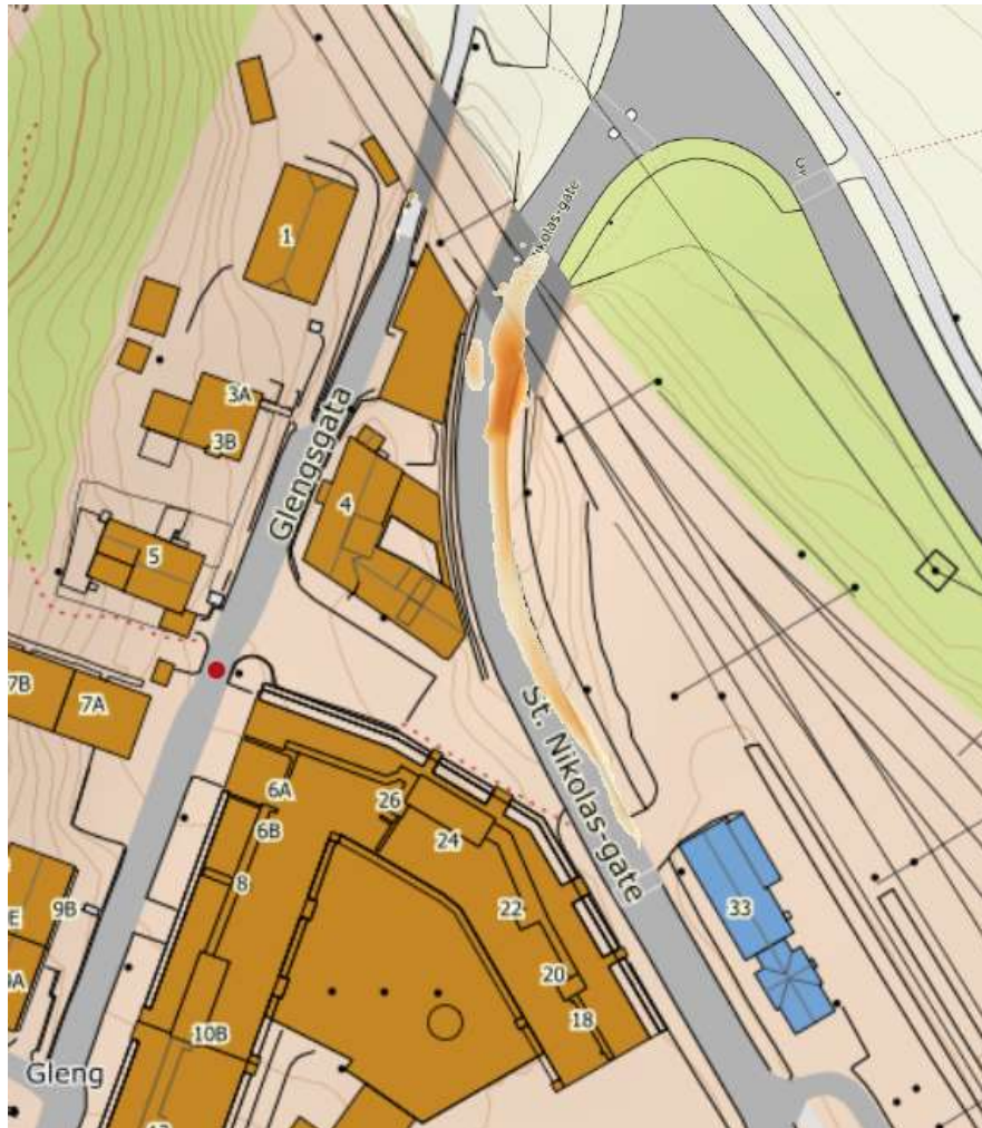
Figur 5 - Utsnitt fra SCALGO Live som viser DV-tall over 0,3 i undergangen ved jernbanen.
