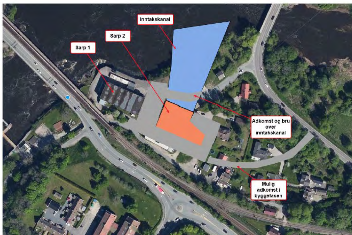
Figur 4-1 Plassering av inntak og inntakskanal. Kilde: Norconsult
